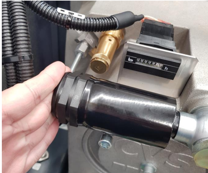
Fig. 29: La main sur le séparateur à cyclone
