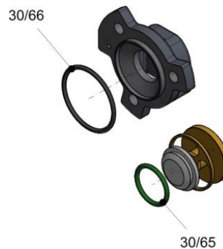
Fig. 52 : Vérifier les joints toriques (pos. 30/65, pos. 30/66)
