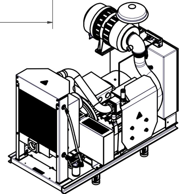
Bei dem mit X gekennzeichnete Maß muss ein Platz von ca.500mm vorbehalten werden um die Luftfilterpatrone zu wechseln.
